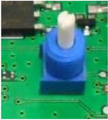
Dieses Potentiometer dient zur Anpassung der Schließgeschwindigkeit. Es gibt 4 Einstellmöglichkeiten: 70%, 80%, 90%, 100% der Maximalgeschwindigkeit. Die Geschwindigkeit der ersten Umdrehung des Schließvorgangs kann nicht beeinflusst werden. Standardeinstellung: 100%. (Display-Anzeige 99%)
