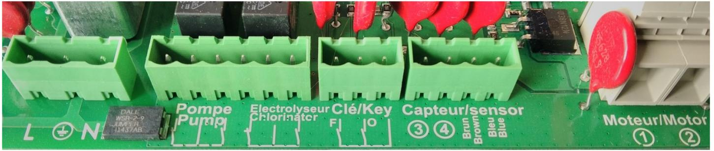
Um die Installation zu vereinfachen, werden die steckbaren Anschlussklemmen getrennt in einer Tüte geliefert. Die Kabel werden gemäß den nachstehenden Anweisungen an die Anschlussklemmen angeschlossen.
