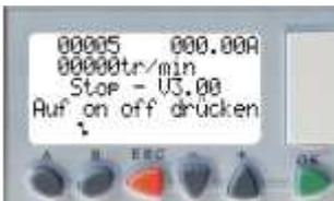
Wenn dieser Fehler 3 Mal beim selben Öffnungs- oder Schließvorgang auftritt, blinkt im Display die nebenstehende Meldung auf. Zum erneuten Initialisieren des Systems muss der Ein-/Ausschalter auf der Vorderseite der Steuerung betätigt werden.
