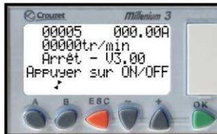
Sur le même cycle d'ouverture ou de fermeture, si cette erreur se produit 3 fois, cet affichage clignotera avec l'écran ci-contre. Pour réinitialiser le système, il faut appuyer sur l'interrupteur Marche-Arrêt du coffret.
